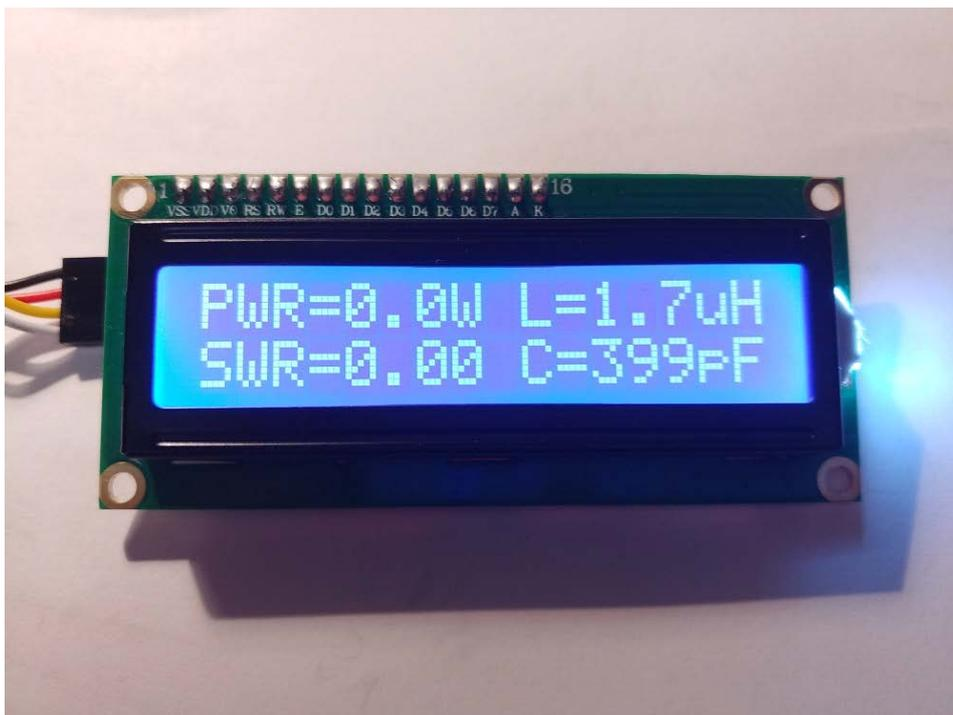
Den venstre side af displayet viser **OUTPUT** og **SWR**. Hvis peak detektortilstand bruges, til at måle transmitterens output, når man bruger forskellige typer modulation.
